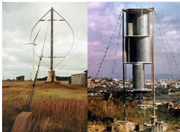
Fig. 4.2.1 – Exemplo de rotor Darrieus e Savonius
