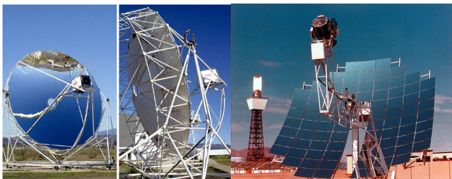
Fig. 3.3.1 – Coletores tipo Parabolóide de Revolução I
